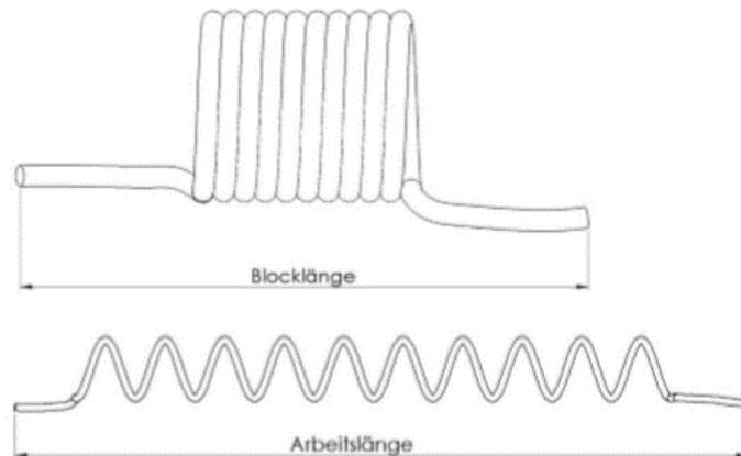
\*Die Arbeitslänge ist die maximal zulässige Streckung (Grenzwert). Nach überschreiten des Grenzwertes kann eine bleibende Verformung eintreten.
